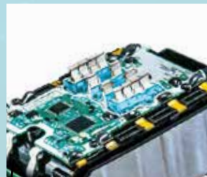
Struktur zur Verhinderung von Kurzschlüssen
