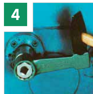
STAHLWILLE Schlag-Ringschlüssel Nr. 8 mit Doppelsechskant sind stärker, dünner und höher.
