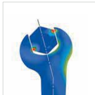
Belastungszonen bei Schraubenschlüsseln von STAHLWILLE
