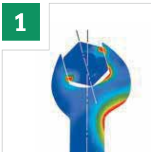
Belastungszonen bei handelsüblichen Schraubenschlüsseln
